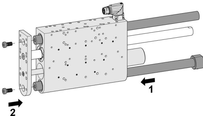
**3. Neue Führungswellen mit der vorderen Montageplatte fest verschrauben**
