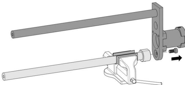
**2. Hintere Montageplatte von Führungswellen lösen**
