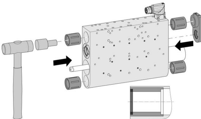
**6. Neue Linearkugellager einsetzen**
