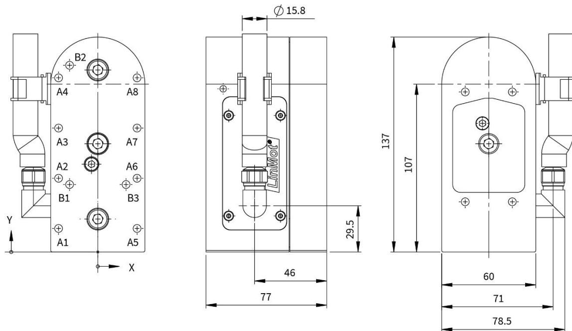
Länge Kabel / Schutzschlauch = 2000 mm / 1250 mm
