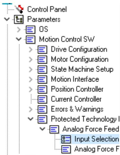
Eingelogggt im Drive finden Sie in der LinMot-Talk Software unter dem Pfad „Parameters -> Motion Control SW -> Protected Technology Functions -> Analog Force Feedback Control“ alle einzustellenden Parameter.
