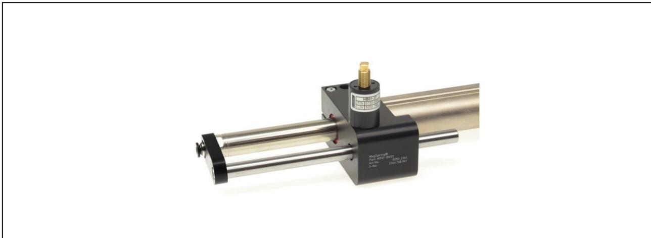
Als Option kann eine Bremse am Linearmotor angebracht werden. Die pneumatische Bremse wird vom Servo Drive angesteuert. Zum Öffnen und Schliessen der Bremse wird zusätzlich noch elektrisches Magnetventil benötigt. Die Bremse wirkt auf die zum Läufer parallel angeordnete Welle und wird mittels Druckluft gelöst.
