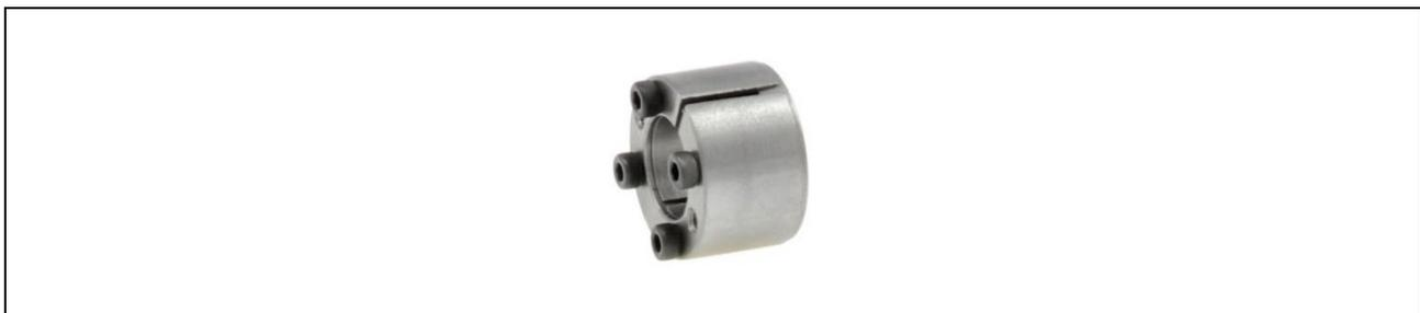
Da bei Hubdreh-Motoren sowohl eine Dreh- als auch eine Linearbewegung ausgeführt wird, muss eine Lastbefestigungsart an der Welle gewählt werden, die sowohl Drehmomente als auch Kräfte in Längsrichtung aufnehmen kann. Mithilfe von einem Spannsatz wird eine kraftschlüssige Verbindung hergestellt.
