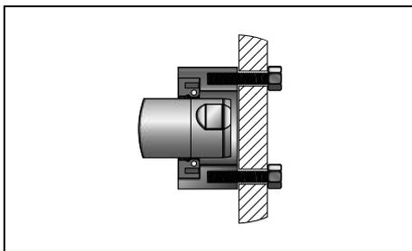
Im Loslager wird der Läufer axial gelagert. Es lässt kleine Bewegungen in Radial- und Längsrichtung zum Läufer zu.
