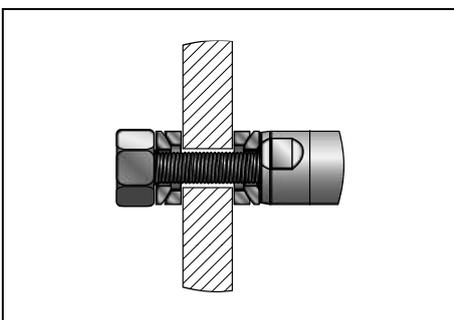
Das Festlager bestehend aus zwei Kugelscheiben und zwei Kegelpfannen erlaubt die feste Montage des Läufers in Bewegungsrichtung. Zudem ermöglicht es den Ausgleich von Radial- und Winkelversatz.
