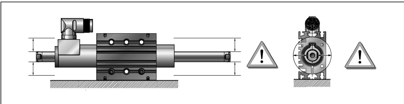
Beim Einbau von Linearmotoren in Module mit metallischen Teilen in unmittelbarer Nähe des Läufers können aufgrund der magnetischen Anziehung oder aufgrund von Wirbelströmen unerwünschte Kräfte auftreten. Diese äussern sich meist in einer holprigen und ruckartigen Positionierung oder einer reduzierten Dynamik des Linearmotors. Um dies zu verhindern, sind bei der Konstruktion mit metallischen Materialien in unmittelbarer Nähe zum Läufer Minimalabstände zu berücksichtigen.
