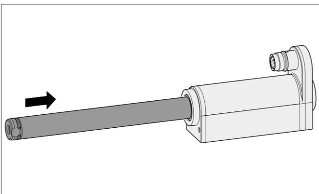
3. Einführen des Läufers in den Stator nach definierter Einbaurichtung (siehe nächsten Montageschritt).
