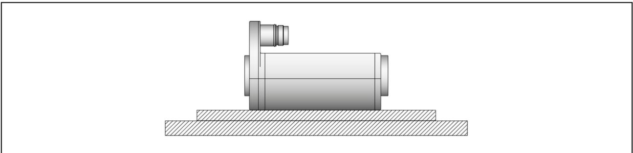
Der Motor wird eben ausgerichtet und mithilfe der Gewindebohrungen an der Motorunterseite mit dem Untergrund verschraubt. Die Positionen der Gewindebohrungen sind im Kap. 8 «Abmessungen» abgebildet.
