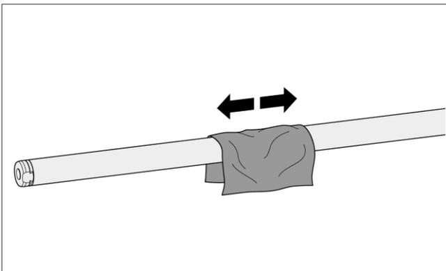
1. Reinigen des Läufers mit einem Papiertuch.
