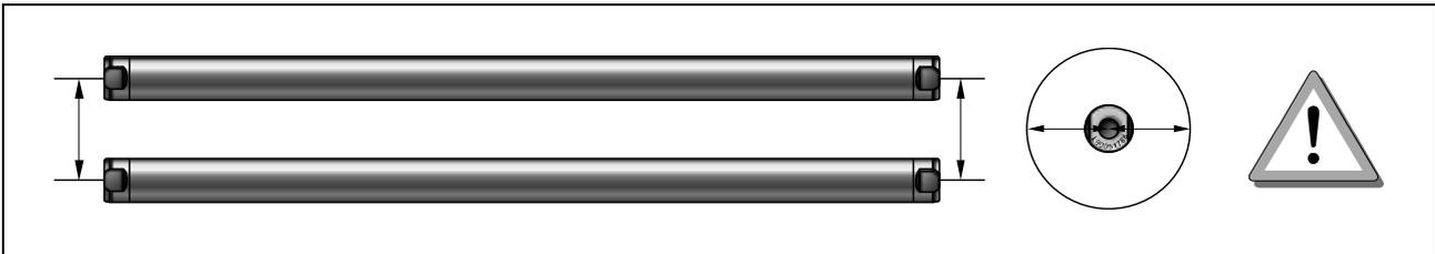
Die Läufer bestehen aus Neodym Magneten und haben eine starke Anziehungskraft. Es muss ein Minimalabstand eingehalten werden. Hierdurch wird zum einen das Risiko von Quetschungen minimiert und zum anderen beeinflussen sich die Läufer durch Ihre Magnetfelder nicht gegenseitig.
