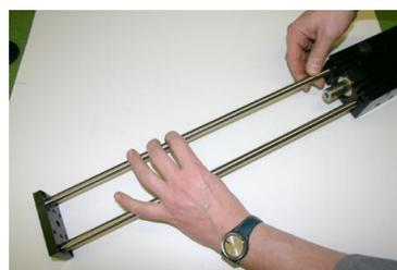
Einschieben der Führungseinheit. (auf Montage Loch für Läufer des achten).
