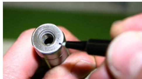
Läuferende mit eingelaserter Seriennummer
