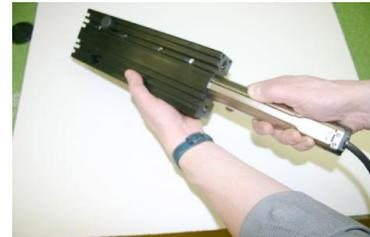
Stator einführen (Klemmelemente müssen ausgerichtet sein!)
