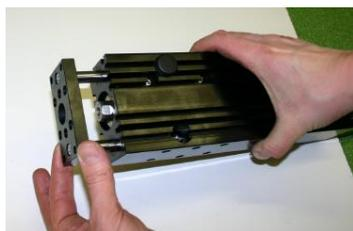
Auf Leichtgängigkeit überprüfen. Führungsstangen mit Kugellagerfett schmieren Z.B. SKF LGMT 2
