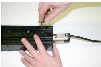
Stator mit Klemmschrauben fixieren (200 Ncm (1.47 ft lbs) Anzugsdrehmoment).
