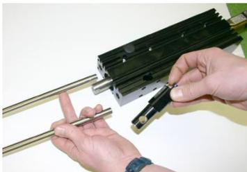
Einzelteile: Führungseinheit, Führungsflansch mit Motor und Bremseinheit
