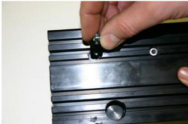
Einführen der Klemmelemente in den Führungsflansch
