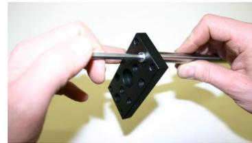
Führungsstangen mit Schraube an Montageplatte befestigen (mit Gewindegewissung z.B. Loctite243 sichern).
