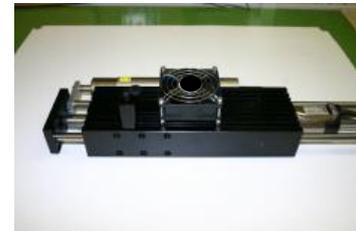
Montierte Einheit mit Kühlventilator. Ventilator muss in Richtung Flansch blasen!
