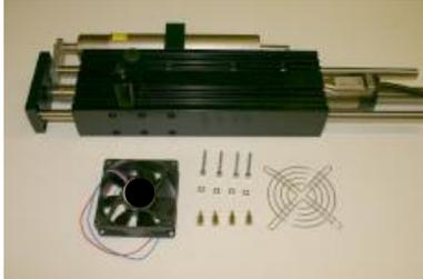
Ventilator (Blasrichtung gegen Flansch) mit Schutzgitter, Abstandhalter und
