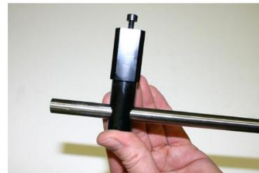
Funktion: Die Bremse umfasst die Führungsstange und klemmt diese fest.
