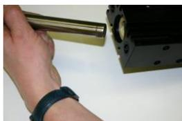
Läufer mit LinMot LU02 Fett **einfetten** (siehe Beilage zu Lineararmotoren!) und in Stator einführen (Läuferende ohne Seriennummer von vorne einführen, dazu evt. Seegering entfernen, wenn vorhanden)
