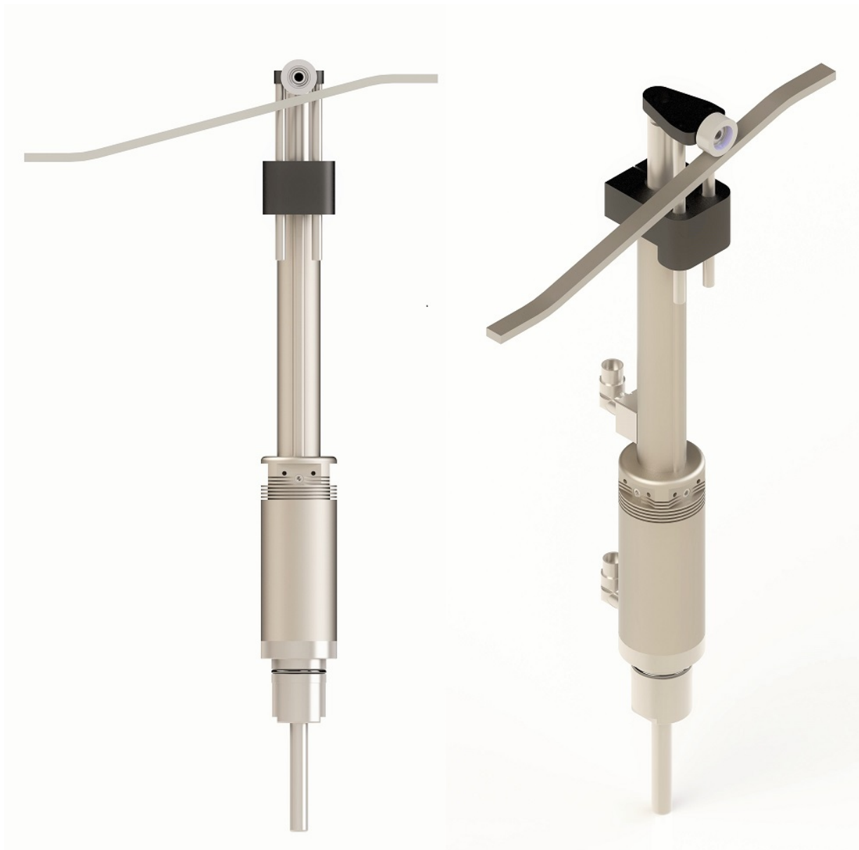
Abbildung: Kulisse fährt den bewegten Teil des Hubdreh-Motors im Fall eines Stromausfalles in der kritischen Zone zwangsweise nach oben. (Achtung: Endanschlag ist nicht eingezeichnet!)
