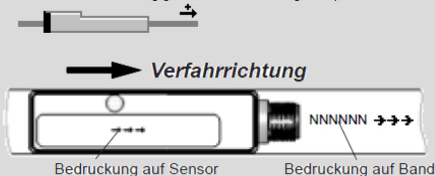
Die Grafik zeigt Sensor und Motorausrichtung für «Zählrichtung Positiv»
